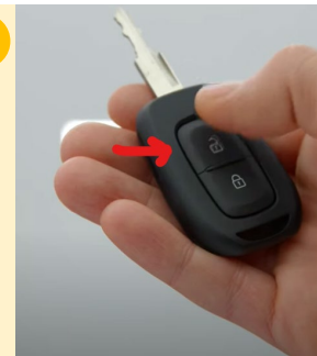
Je déverrouille la trappe et libère le câble en appuyant sur le bouton de la clé
